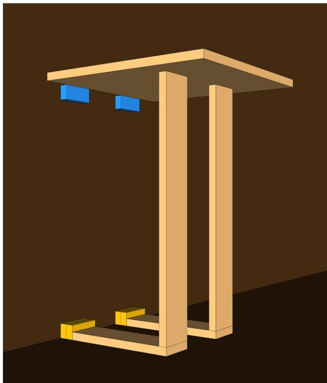
Commencez par percer vos pièces de fixation comme sur le schéma ci-contre, en bleu les pièces du haut, en jaune celles du bas.
